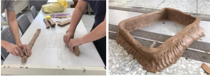
4 完成圍範後，用筆刷沾油在圍範內輕塗薄薄一層，以免石膏液凝固後咬合採集區塊。
