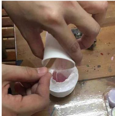
圖說 2-2：攪拌後，再倒入模具作為第一層
